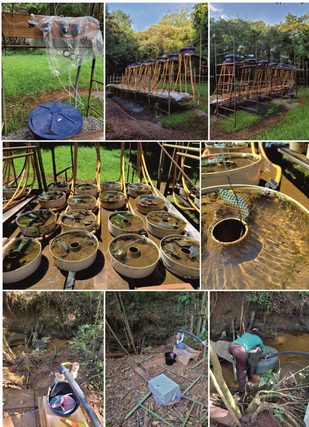
Figura 1. Estrutura ExStream: Pulsador responsável pela distribuição das concentrações de nitrato para os tanques principais; estrutura completa mostrando os tanques principais; mesocosmos simulando pequenos riachos exibidos com mais detalhes; riacho ao qual a estrutura da bomba foi instalada para abastecer os mesocosmos. (Fotos: equipe ExStream BR).
